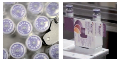
Vollautomatisch werden in Hochgeschwindigkeit zeitweise über 300 Packungen BOTOX® in der Minute fertig gestellt.
